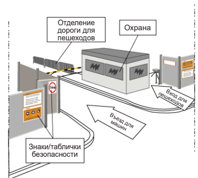
Рис. 1. Защита строительной площадки
